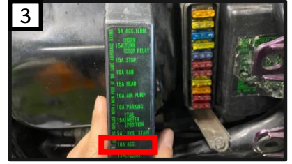
3 스위치의 파란색 선을 오토바이 ACC에 연결하고, 스위치는 핸들그립에 고정합니다. (왼쪽 또는 오른쪽에 고정합니다.)
